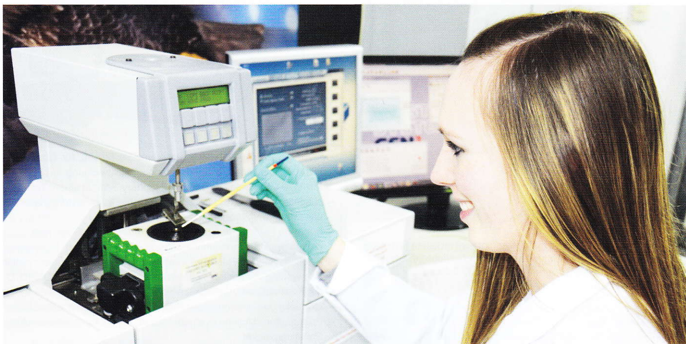
Vollautomatischer Lötbarkeitstest mit Benetzungswaage: Zeigt der Lötbarkeitstest Auffälligkeiten, so lässt sich die Lötbarkeit mithilfe der von HTV entwickelten Aufbereitungsverfahren wiederherstellen.
