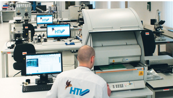
Abb. 2: Probeninspektion mittels Röntgenfluoreszenz-Analyse
