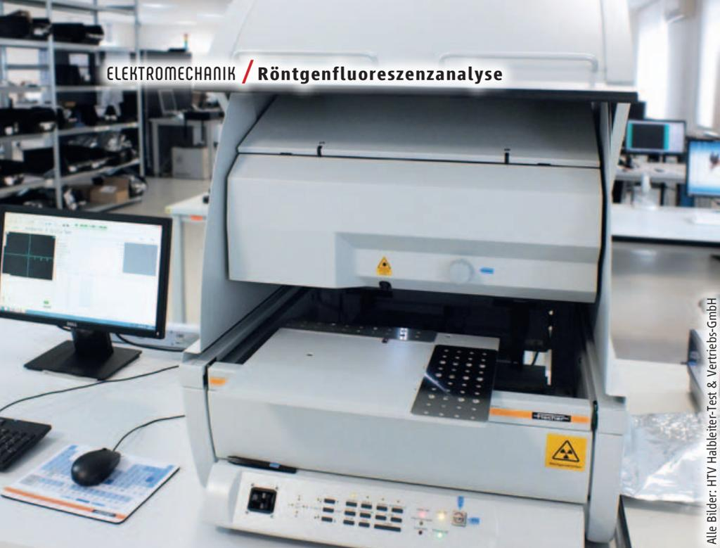
Mit einem Röntgenfluoreszenz-Analysegerät lassen sich Beschichtungen schnell und effektiv untersuchen.
