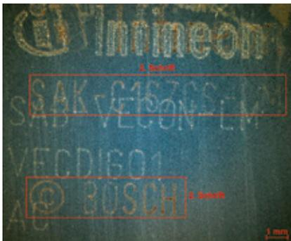
Hinweis auf Bauteilmanipulation nach Wischtest (Bild: HTV Halbleiter Test & Vertriebs-GmbH)
