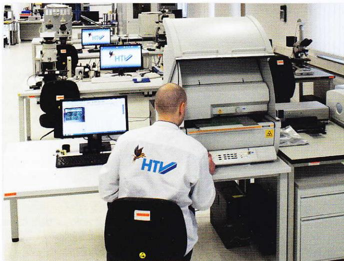
Bild 2: Probeninspektion mittels Röntgen-Fluoreszenz-Analyse
