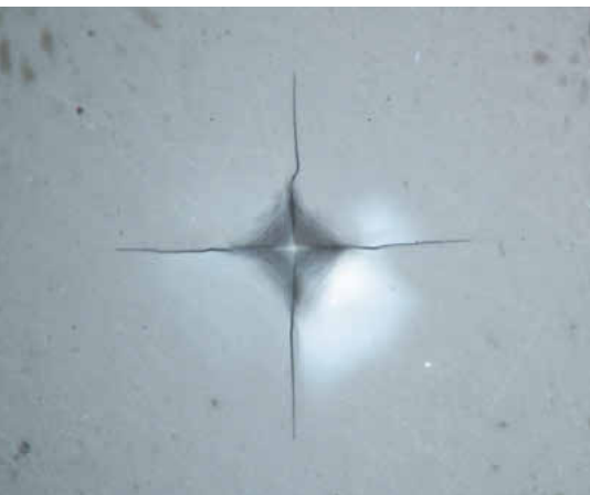
Mikroskopische Aufnahme eines Vickersindents in PMMA, einem transparenten thermoplastischen Kunststoff, der landläufig als Acrylglas bekannt ist
