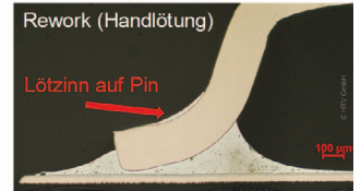
Bild 6: Schliffbilder durch die Lötstellen der SOP-Bauteile
