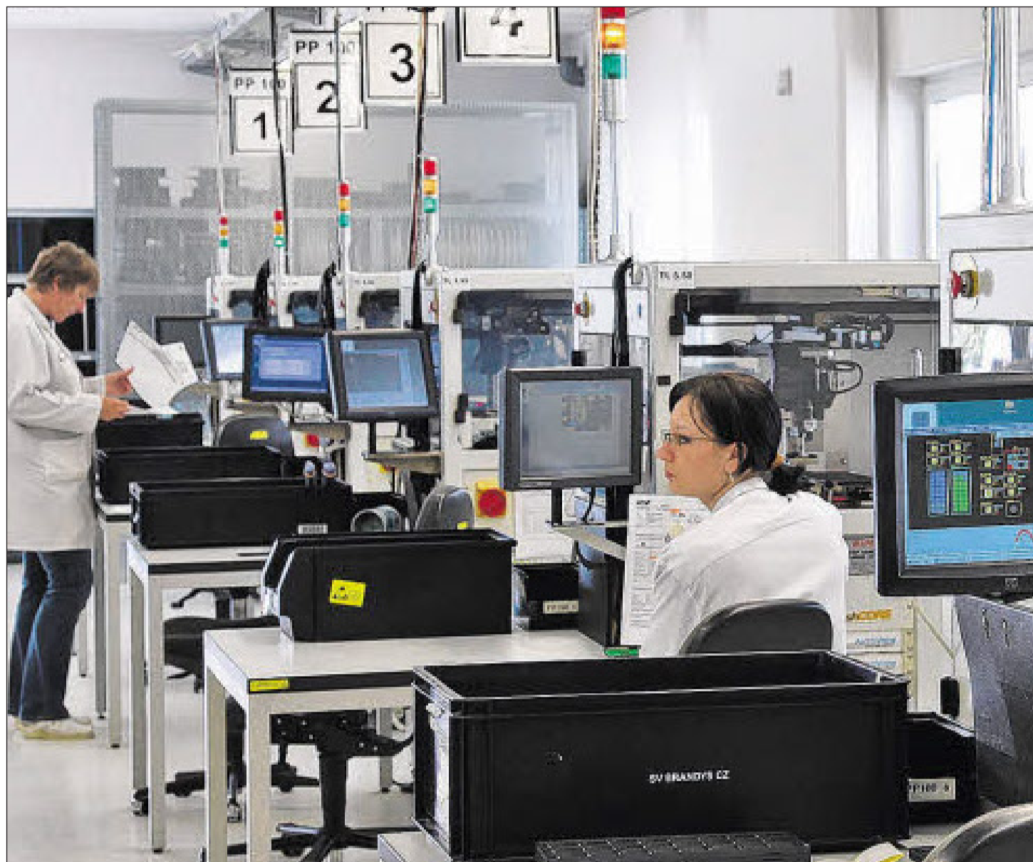
Die Guten ins Töpfchen, die Schlechten ins Kröpfchen. Hier programmiert HTV an hochmodernen Anlagen Speicherchips, die anschließend in Autos eingebaut werden, in Flugzeuge und Züge. Oder auch in Handys.
