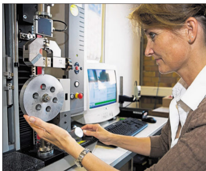
An diesem Prüfstand am Stammsitz Weinheim kontrolliert eine Freudenberger-Mitarbeiterin einen flexiblen Flachleiter (rot), der in verschiedenen elektronischen Geräten wie Handys Verwendung findet. FOTO: FREUDENBERG
