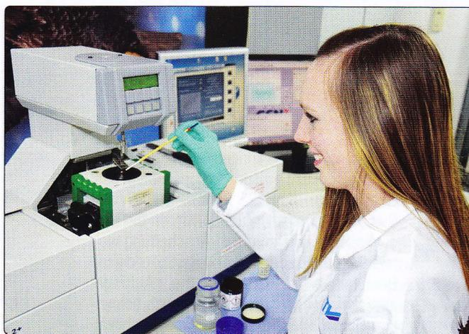
**Vollautomatischer Lötbarkeitstest zur Beurteilung der Verarbeitbarkeit elektronischer Komponenten**
