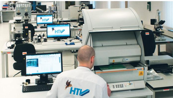
Abb. 2: Probeninspektion mittels Röntgenfluoreszenz-Analyse
