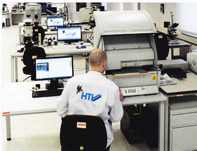
Bild 2: Probeninspektion mittels Röntgen-Fluoreszenz-Analyse
