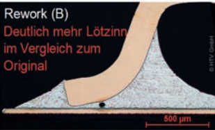
Abb. 9: Schliffbild durch die Lötstellen der SOP-Bauteile
