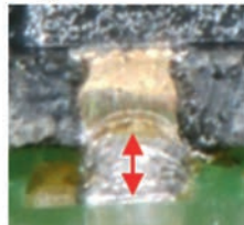
Abb. 7: Erkennbare Unterschiede in der Lotmenge bei den QFN-Bauteilen
