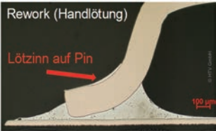
Abb. 9: Schliffbild durch die Lötstellen der SOP-Bauteile
