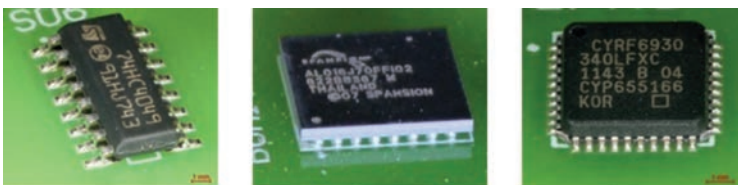
Abb. 1: Verschiedene Bauteile – verlötet auf der Testleiterplatte (links: SOP, Mitte: BGA, rechts: QFN)
