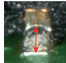
Abb. 7: Erkennbare Unterschiede in der Lotmenge bei den QFN-Bauteilen
