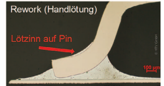
Bild 6: Schliffbilder durch die Lötstellen der SOP-Bauteile
