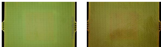
Abbildung 4: Verfärbte Leiterplattenrückseite. Links: Original. Rechts: Verfärbung nach dem Rework.
