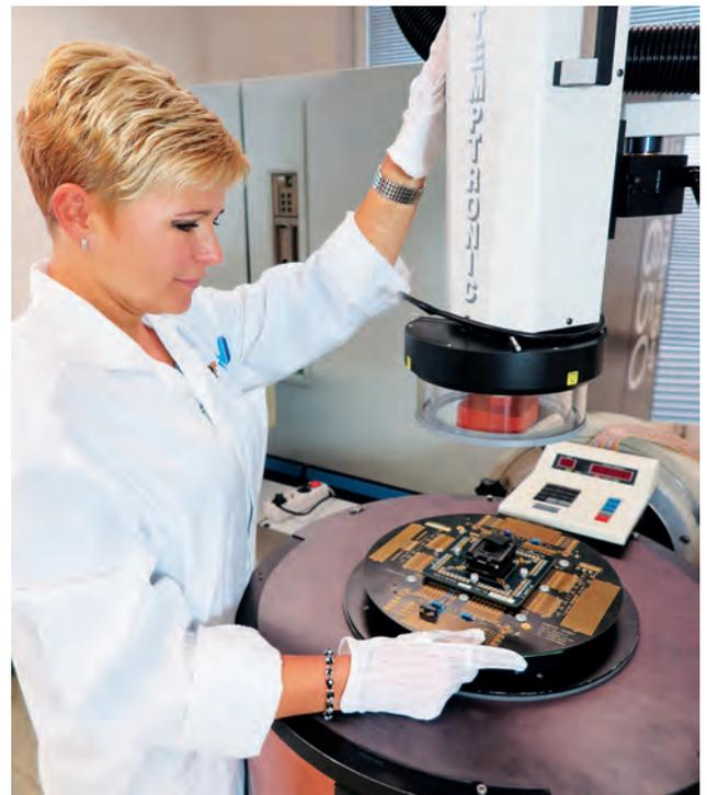
*Elektrischer Test mit dem ThermoStream*
