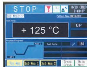
Tests mit Temperaturschock von -60 bis +125 °C sind insbesondere für die Branchen Luft- und Raumfahrt sowie Militär von essentieller Bedeutung
