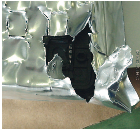
Bild 2: Drypack mit einer beschädigten Ecke
