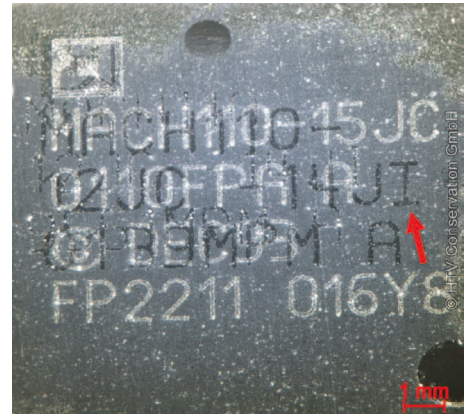
Bild 4: Doppelte Beschriftung nach Wischtest
