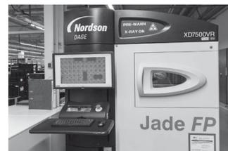
**Röntgeninspektion in der Elektronikfertigung**
