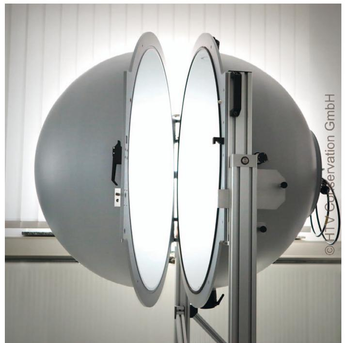
Ulbricht-Kugel mit 1 m Durchmesser zur Vermessung des Lichtstroms
