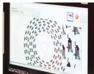
**Bauteilezählen per Röntgensystem**
