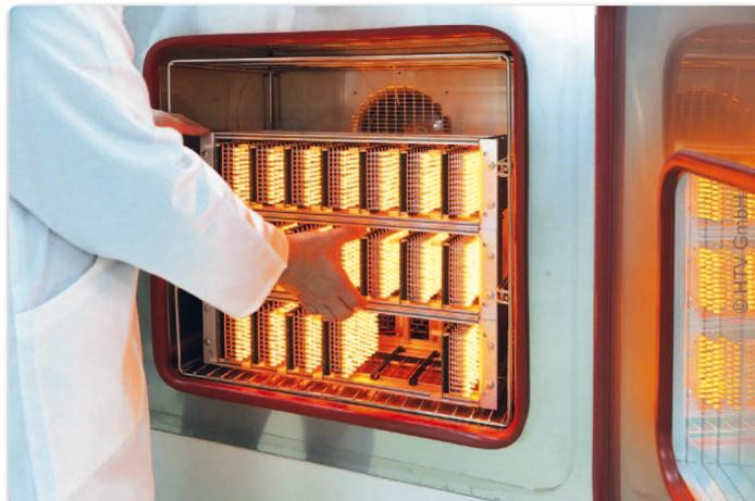
Bestromung von LEDs zur Voralterung in Klimakammer
