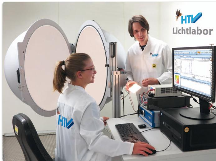
**Blick ins HTV-Lichtlabor: Ulbricht-Kugel mit 1 m Durchmesser zur Vermessung des Lichtstroms**
