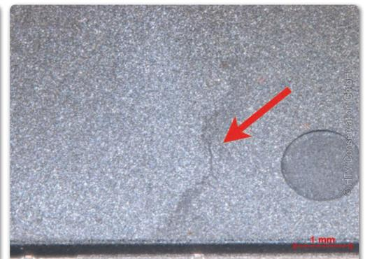
Delamination im Gehäuse nach Wärmebehandlung (l.)
