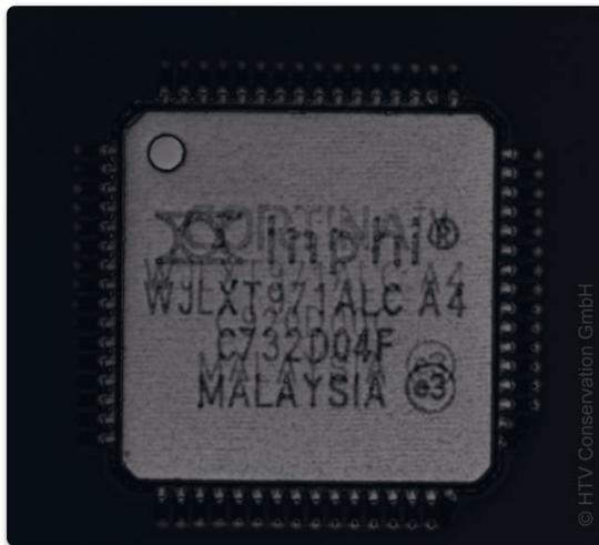
**Bauteil mit visuell nur einer erkennbaren Lasermarkierung (l.). Erst bei der Analyse mit dem Ultraschallmikroskop zeigt sich, dass das Bauteil eine tieferliegende, überdeckte Lasermarkierung besitzt und gezielt manipuliert wurde (r.)**
