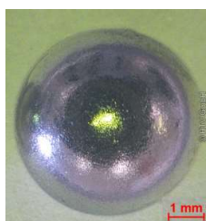
Abbildung 2: Umgeschmolzene Lotpaste auf Leiterplatte
