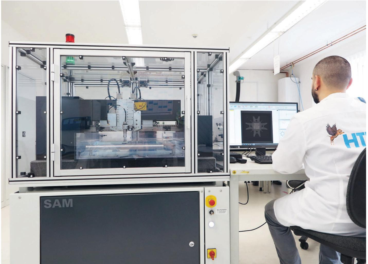
Ultraschallmikroskop bei HTV im Einsatz
