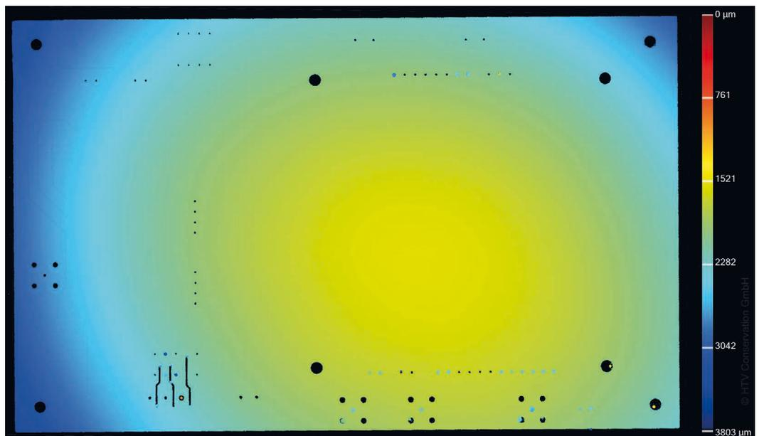
**Leiterplatte mit gewölbter Oberfläche. Die Messdaten lassen sich in einer Falschfarben-Karte darstellen. Es zeigt sich eine leicht elliptische Erhebung in der Mitte der Leiterplatte.**
