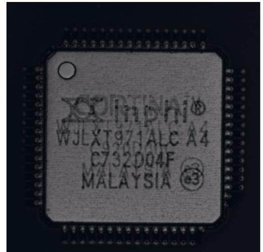
**Bauteil mit visuell nur einer erkennbaren Lasermarkierung (links). Erst bei der Analyse mit dem Ultraschallmikroskop zeigt sich, dass das Bauteil eine tieferliegende, überdeckte Lasermarkierung hat und gezielt manipuliert wurde (rechts).**
