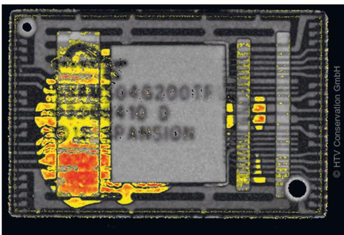
Delamination im Gehäuse nach Wärmebehandlung
