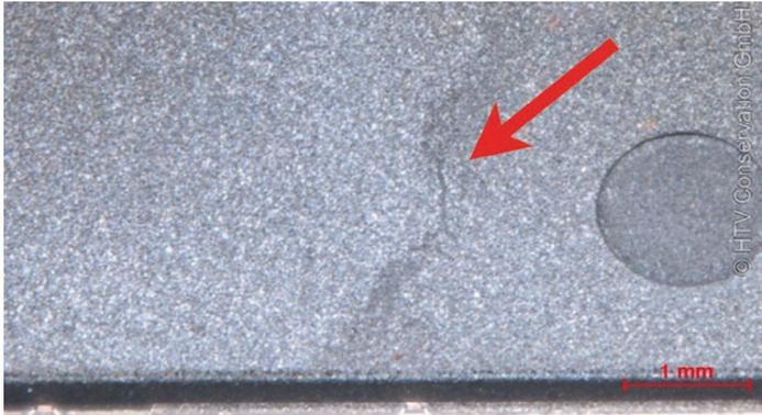
**Riss im Gehäuse nach Feuchtigkeitsexposition mit anschließendem Reflow-Lötprofil**
