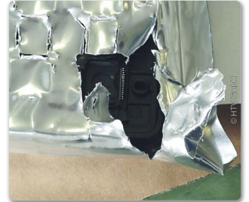
Vergrößerte Aufnahme eines defekten Dry-Packs
