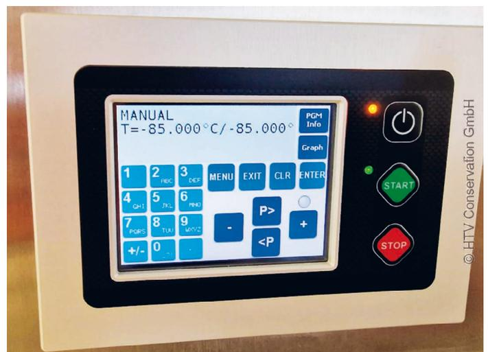
Tieftemperatur-Kalibrierbad mit hoher Temperaturstabilität bei exakt -85°C
